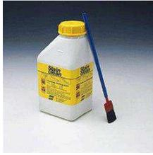
Травильная паста Stain Clean предназначена для восстановления коррозионностойких свойств нержавеющей стали, изменивших свой цвет и потерявших хром в результате сварки.
