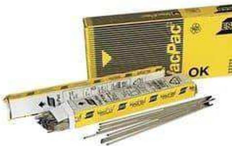
OK 62.53 – электрод нержавеющей стали, предназначенный для работы с постоянным (+) и переменным током, подходит для создания коротких швов. Покрытие рутиловое, обеспечивает спокойное расплавление металла при незначительном количестве брызг. За счет TiO<sub>2</sub> в составе покрытия повторное зажигание дуги проходит с легкостью – стержень не соприкасается с основным металлом.
