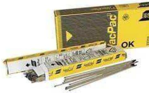
Электрод модификации OK 73.79 имеет основной тип покрытия и структуру, легированную 3,5% никеля. Такой структурный состав, включающий также медь, фосфор и марганец, обеспечивает прочность соединения низколегированных и низкоуглеродистых сталей.
