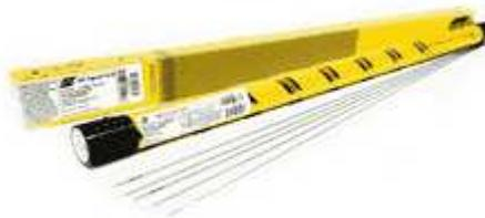
OK Tigrod 13.32 – продукция бренда ESAB, разработанная для сварки высокопрочных (с пределом прочности более 1500 МПа), окалиностойких и перлитных низколегированных хромомолибденовых (теплоустойчивых) сталей при постоянном токе прямой полярности. Представляет собой пруток омедненный, легированный хромомолибденом. Температурный режим эксплуатации изделий не должен превышать 600 градусов Цельсия.
