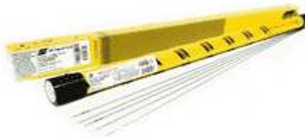
Сплошной омедненный пруток, в состав которого включены 8.5-10.5% хрома и 0.85-1.2% молибдена. Применяется для сваривания теплоустойчивых высокопрочных хром-молибденовых сталей с подобным процентным содержанием в составе легирующих добавок и предельной эксплуатационной температурой ниже 585°C. Допускается наличие в составе небольшого количества ванадия, никеля и ниобия.
