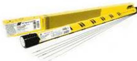
Омедненная структура сварочного прута модификации OK Tigrod 13.37 с содержанием молибдена, магния, хрома и дополнительных компонентов эффективно применяется для аргодуговой сварки. Прут OK Tigrod 13.37 предназначен для сваривания металлов с однородной структурой, подвергающихся эксплуатации в условиях повышенных температурных нагрузок, сульфидных коррозионных факторов.
