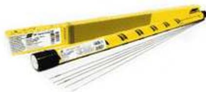
Сплошная проволока из нержавеющей стали, которая содержит в составе 24-26% хрома, 9-10.5% никеля и 3.5-4.5% молибдена. Шов, выполненный с помощью этого прутка, характеризуется крайне высокой прочностью, сопротивляемостью к питтинговой коррозии и пластичностью. Пруток пригоден для сваривания:
