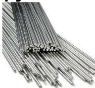
Пруток по своим свойствам и назначению близок к OK Tigrod 347LSi, но рекомендуется к применению, когда повышенное содержание кремния является нежелательным. Например, когда при сварке конструкции существует повышенная опасность образования горячих трещин. Содержание ферритной фазы в наплавленном металле в исходном после сварки состоянии составляет ~4,5% (FN ~8).
