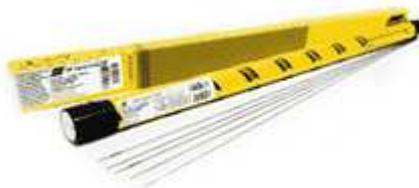
OK Tigrod 318Si – пруток присадочный, предназначенный для работы в среде  $ArO_2$  или  $ArCO_2$  с нержавеющей стали с номинальным содержанием хрома (18%) и никеля (10%), т.е. аустенитными. Результат сварки – высококачественный сварной шов.
