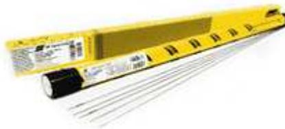
Электрод OK Tigrod 308L - специальный антикоррозионный пруток с повышенным содержанием хрома и никеля (18% и 8% соответственно) для аргонодуговой сварки изделий из нержавеющей стали. Сварка производится в среде чистого аргона с помощью сварочных аппаратов TIG постоянного тока.
