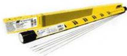
Ферритная проволока для сварки из нержавеющей, легированная 16.5-18.5% хрома, 0.5-1% кремния и 0.3-0.7% титана. Сварочный шов коррозионно-стойкий, в том числе и к межкристаллитному разрушению, и отлично выдерживает воздействие агрессивной сернистой среды.
