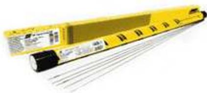
Пруток для аргонодуговой сварки марки OK Tigrod 16.95 выполнен из нержавеющей стали с композитной структурой, содержащей до 5,5-7,5 % марганца, 17,0-20,0% хрома и 7,0-10,0 никеля. Кроме того, в структурном составе модификации прутка OK Tigrod 16.95 содержится равномерно распределенный феррит.
