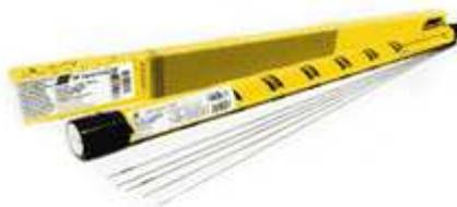
OK Tigrod 309MoL - специальный противокоррозионный стальной пруток с повышенным содержанием молибдена для аргонодуговой сварки соответствующих видов разнородных нелегированных и низколегированных сталей. Применяется со сварочными аппаратами постоянного тока в химической промышленности, машиностроении, приборостроении. Пруток содержит 22% хрома, 14% никеля, до 2,7% молибдена и 1,6% марганца.
