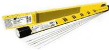
OK Tigrod 309L - стальной присадочный пруток с повышенными антикоррозионными свойствами. Предназначен для сварки разнородных материалов (например, нержавеющей стали с одной стороны и низколегированной стали с другой). Используется в режиме аргонодуговой сварки TIG при постоянном сварочном токе.
