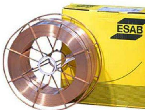
Weld 71T-1 – это рутиловая электродно-присадочная проволока, предназначенная для сварки в полуавтоматическом режиме при изолировании рабочей зоны углекислым газом. Она применяется для работы с углеродистыми, нелегированными и низколегированными конструкционными сплавами с любым положением шва. Для работы используется постоянное напряжение обратного направления.
