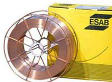
Модификация порошковой проволоки OK Tubrod 14.12 выпускается диаметром 1,0-1,6 мм и предназначена для производства всепозиционных сварочных швов. Данная марка применима для сварочных работ в условиях газовой среды M21, а также в условиях чистой углекислоты C1. Использование модификации OK Tubrod 14.12 сварной проволоки практикуется при любой полярности постоянного тока.
