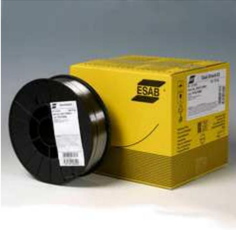
Рутитовая всепозиционная (кроме вертикали на спуск) порошковая проволока, предназначенная для сварки в аргон-кислородной смеси M21 сосудов работающих под давлением, ректификационных колонн, каталитических реакторов и т.п. из теплоустойчивых сталей типа 1,0...1,25%Cr-0,5%Mo (15XM, 20XM, 20XML, T/P11, T/P12, 13 CrMo 4-5, 10 CrMo 5-5, W.No 1.7335 и им аналогичных) с максимальной температурой эксплуатации до 545°C.
