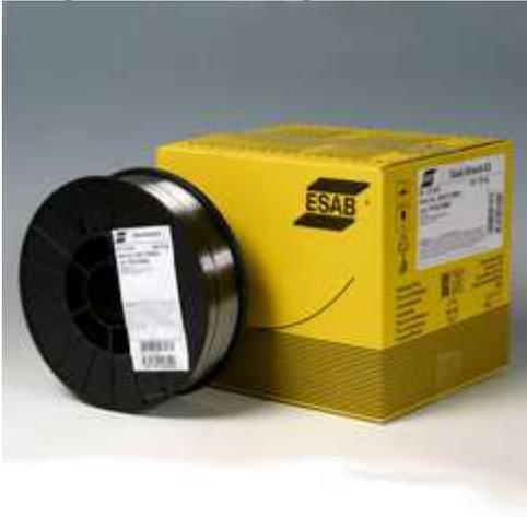
Рутиловая всепозиционная (кроме вертикали на спуск) порошковая проволока, предназначенная для сварки в аргон-кислородной смеси M21 сосудов работающих под давлением и бойлеров из теплоустойчивых сталей марок 15M, T/P1, 16Mo 3, W.No 1.5415, 8 MoB 5-4 и им аналогичных с максимальной температурой эксплуатации до 460°С.
