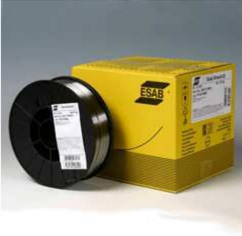
Рутитовая всепозиционная (кроме вертикали на спуск) порошковая проволока, предназначенная для сварки в аргон-кислородной смеси M21 пароперегревателей, реакторов, печей, труб, коксовых барабанов, колонн гидрокрекинга нефти и т. п. из теплоустойчивых сталей типа 2,0...2,5%Cr-1,0%Mo (10X2M, T/P11, T/P22, 10 CrMo 9-10, W.No 1.7380 и им аналогичных) с максимальной температурой эксплуатации до 545°C.
