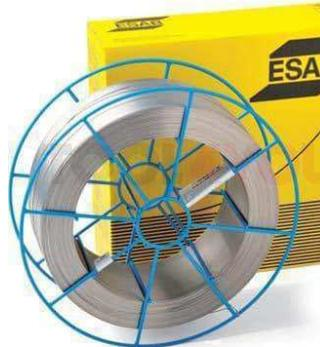
OK Tubrod 14.28 – проволока рутиловая порошковая, используется при сваривании ферритно-аустенитных сталей в газовой смеси Ar / 20% CO<sub>2</sub>. Материал отличается высокой степенью сопротивления коррозии и гарантирует формирование гладкого шва благодаря рутиловой основе. В процессе работы с материалом легко отделяется шлаковая корка.
