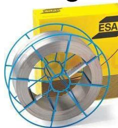
Модификация сварной проволоки Shield-Bright 316L характеризуется пониженным содержанием углерода, предназначена для полуавтоматической сварки в углекислотной и аргонной среде. Данная марка относится к категории всепозиционных проволочных рутиловых материалов, отличается от сплошных проволок отсутствием кремниевых бляшек при формировании сварного шва.
