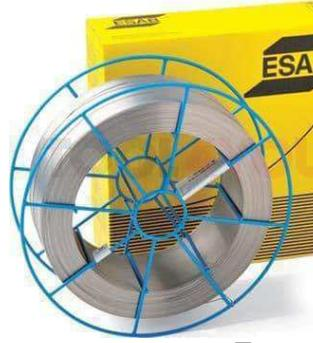
Металлопорошковая проволока из группы газозащитных рутиловых. Предназначена для сварочной и родственной обработки м/к из высоколегированных дуплексных сталей в среде чистой углекислоты или стандартной аргоновой смеси M12. OK Tubrod 14.27 может также применяться для стыкового соединения деталей из конструкционных низкоуглеродистых и аустенитно-ферритных сплавов.
