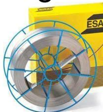
Shield-Bright 308L Xtra – порошковая проволока рутилового типа разработанная для сваривания аустенитных нержавеющих сталей в нижнем положении. Работа с материалом проводится в чистом диоксиде углерода (без потери качества сварки) или в традиционной аргоновой смеси.
