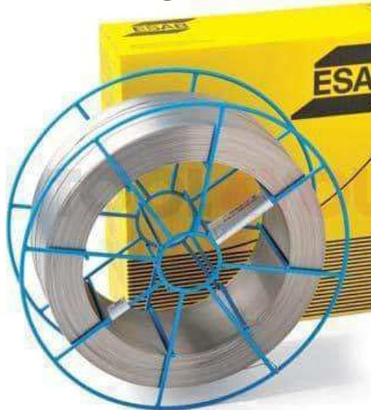
Проволока Shield-Bright 309L X-tra предназначена для выполнения работ по сварке различных видов сталей, в том числе, нержавеющей, жаропрочных, углеродо-марганцевых, с ограниченной свариваемостью. Также ее применяют для выполнения наплавки. Данная продукция отличается показателем прочности 600 МПа. При этом параметр текущей прочности составляет 480 МПа. Проволока широко используется в разных отраслях промышленности: химической, нефтяной, пищевой, в судостроении и машиностроении.
