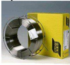
Всепоозиционная (кроме вертикали на спуск) высокопрочная рутиловая порошковая проволока, предназначенная для сварки в аргоновой смеси M21 заполняющих и облицовочных проходов магистральных трубопроводов из высокопрочных сталей с пределом текучести до 690 МПа. Наплавленный металл обладает высокой ударной вязкостью при температурах до -40°С, гарантируя в нем предельно низкое содержание водорода.
