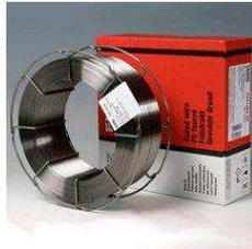
Рутиловая всепоозиционная порошковая проволока для сварки в смеси Ar / CO<sub>2</sub>. Обеспечивает отличную свариваемость, высокие значения ударной вязкости при  $t$  до -50°C и высокую коррозионную стойкость в морской воде. Применяется для сварки судов из сталей NV E460, NV E500 и других сталей с мин. значением временного сопротивления при разрыве до 500 МПа, морских платформ и других конструкций, работающих под воздействием низких температур и морской среды.
