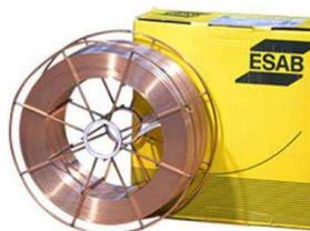
FILARC PZ6138 – порошковая проволока, произведенная корпорацией ESAB для сварки в защитной среде из смеси  $ArCO_2$  в соотношении 80% к 20%. Данный тип получил одобрения от многочисленных международных организаций и имеет сертификаты качества и соответствия. К тому же использование проволоки одобрено НИЦ «Мосты», так что она может быть использована при сварке (наплавке) мостовых конструкций, в том числе и высоконагруженных железнодорожных.
