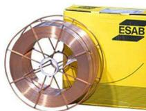
OK Tubrod 15.19 – рутиловая проволока с порошковым наполнителем, предназначенная для работы в аргоновой смеси M21. Дополнительно легирована никелем (содержание в пределах 1%). Характеризуется высокой сопротивляемостью к появлению шлаковых включений.
