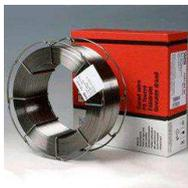
Всепоозиционная (включая вертикаль на спуск) 1,5% Ni легированная рутиловая порошковая проволока, предназначенная для сварки в чистом углекислом газе особо ответственных металлоконструкций из низколегированных конструкционных и судовых сталей повышенной прочности с пределом текучести до 460 МПа типа S460QL1 и им аналогичных. Наплавленный металл обладает высокими пластическими характеристиками и сохраняет высокие показатели ударной вязкости при температурах до  $-60^{\circ}\text{C}$ .
