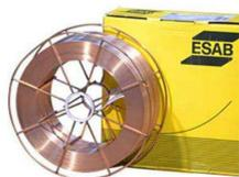
OK Tubrod 15.17 - порошковая сварочная проволока рутилового типа. В состав проволоки входит 0.9% никеля, что обеспечивает прочный ровный шов в любом положении сварки (вертикальное, горизонтальное, потолочное). При этом шов обладает высокими характеристиками ударной вязкости при температуре до -40 градусов С.
