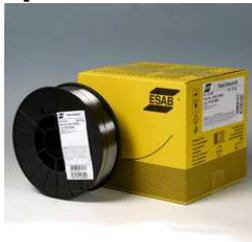
Универсальная всепозиционная (кроме вертикали на спуск) высокопрочная рутиловая порошковая проволока, предназначенная для сварки в аргоновой смеси M21 особо ответственных конструкций из сталей с пределом текучести до 620 МПа, таких как DOMEX 600. Проволока также рекомендуется для сварки заполняющих и облицовочных проходов магистральных трубопроводов класса прочности до K65 (API 5L X80).
