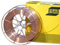
OK Tubrodur 35 G M – порошковая сварочная проволока рутилового типа, с помощью которой соединяют детали из высокопрочной углеродистой стали. Процесс сварки происходит с участием газа CO<sub>2</sub>, выполняющего защитную функцию.
