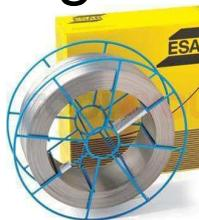
Проволока Shield-Bright Xtra 309LMo отличается небольшим содержанием углерода и высокой производительностью. Она применяется для сварочных работ с нержавеющей, двухслойными и разнородными сталями. Сварка выполняется в чистой углекислоте, а также в аргоновой смеси M2. При этом обеспечивается высокая устойчивость шва к коррозии. При сварке стали хорошо отделяется шлак. Он быстро твердеет и удерживает ванну для сварки в нужном положении.
