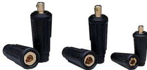
Новое поколение кабельных разъемов, соответствующих требованиям СЕ, с покрытием из неопренового каучука. Разъем штыкового типа, обеспечивающий прочное, безопасное и надежное соединение. Кабель крепится с помощью розетки и двух винтов с внутренним шестигранником.
