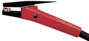
Резак для воздушно-дуговой поверхностной резки поставляется с кабелем длиной 2,14 м. В резак можно устанавливать как круглые, так и плоские электроды: круглые электроды диаметром от 4 мм до 13 мм, либо плоские электроды размером от 10 мм до 16 мм. K4000 рассчитан на номинальный ток 1000 А, подачу сжатого воздуха под давлением от 5,6 до 7,0 кг/см<sup>2</sup>, при этом объем сжатого воздуха составляет от 0,85 до 0,99 м<sup>3</sup>/мин. Вес резака и кабеля составляет 2,4 кг.
