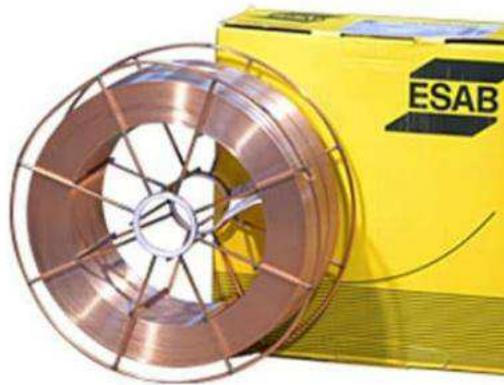
OK Autrod 12.64 – это проволока, предназначенная для сварки специальным полуавтоматом в качестве присадочного материала и плавкого электрода. Она применяется для обработки сталей с небольшим содержанием углерода под защитой углекислого газа или его смеси с аргоном в соотношении до 20/80.
