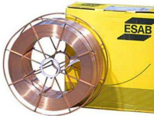
OK AristoRod 12.63 – многофункциональная проволока для сварки с типом обработки по технологии ASC. Предназначение материала – сварка деталей из конструкционных сталей используемых в среде пониженных температур и зн аконеустойчивых нагрузок. Предел текучести металла – до 460 МПа.
