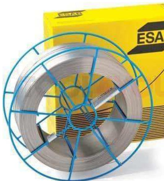
OK Autrod 318Si – непрерывная сварочная проволока из нержавеющей стали. В составе присутствует хром (19%) и никель (12%). Благодаря хрому существенно увеличена твердость и антикоррозионные свойства сплава. Никель также делает проволоку более пластичной и удобной в работе. Небольшое содержание ниобия (0,7%) предотвращает межкристалльную коррозию и разрушение стали. Молибден (2,8%) повышает жаропрочность сплава.
