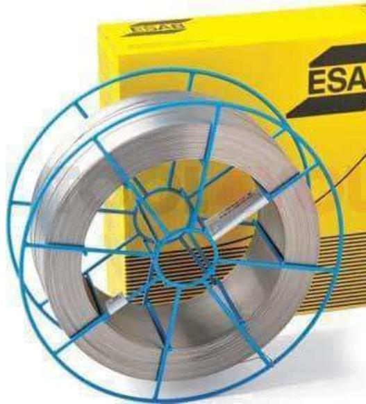
Проволока модификации OK Autrod 385 изготовлена из нержавеющей стали и используется для полуавтоматически х сварных процессов. В результате сварки продуцируется высоколегированный металл с содержанием молибдена, никеля и хрома. Наплавляемый металл имеет предельно низкое содержание углерода, и обладает усиленной прочн остью к нагрузкам статического характера.
