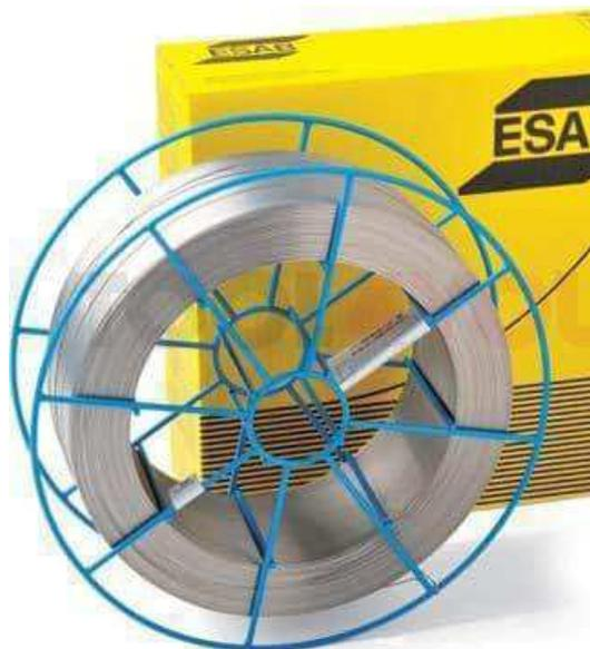
OK Autrod 309LSi – непрерывная сварочная проволока из нержавеющей стали с высоким содержанием хром (24%) и никеля (13%). Благодаря хрому существенно увеличена твердость и антикоррозионные свойства сплава. Никель так же препятствует образованию коррозии, делает проволоку более пластичной и удобной в работе.
