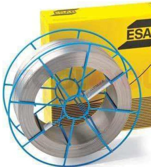
Проволока OK Autrod 310 рассчитана на проведение сварочных работ для нержавеющей с низким процентом содержания углерода и легированных добавок, а также для жаростойких, коррозионно-стойких и даже броневых сталей. Для осуществления качественного наплавления металла применяется полуавтомат при условиях защитной среды на основе чистого аргона, так и с добавлением к нему кислорода, гелия и оксида углерода в соответствующих пропорциях.
