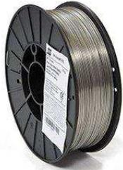
Неомедненная сварочная проволока с уникальной обработкой поверхности ASC (Advanced Surface Characteristics & ndash, поверхность с улучшенными характеристиками), предназначенная для сварки сверх высокопрочных сталей с пределом текучести до 900 МПа, таких как S890QL, WELDOX 900, 1100, 1300, DOMEX 960, XABO 890, 960, 1100, NAXTRA 70, OX-700, 800, 1002, Optim 900QC, 960QC, 1100QC, T1-HY80. Наплавленный металл обладает высокой ударной вязкостью при температурах до  $-40^{\circ}\text{C}$ .
